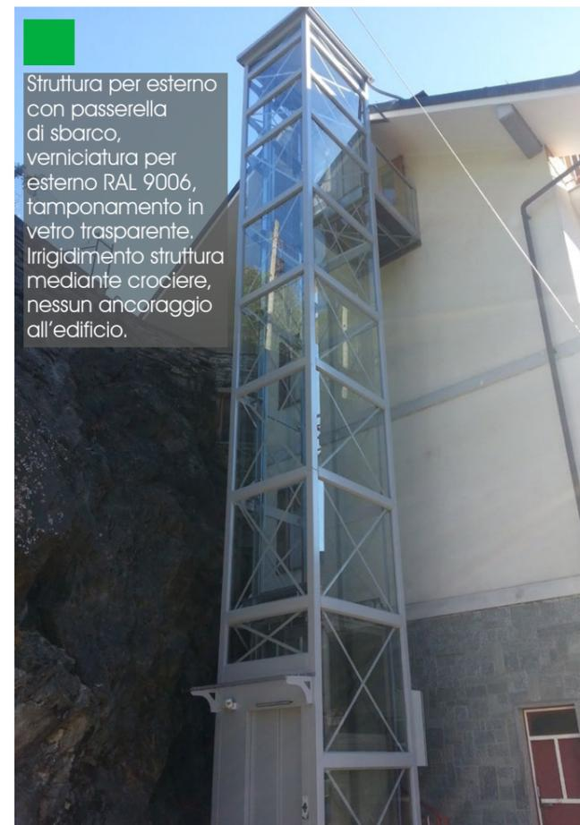
Struttura per esterno con passerella di sbarco, verniciatura per esterno RAL 9006, tamponamento in vetro trasparente. Irrigidimento struttura mediante crociere, nessun ancoraggio all'edificio.
